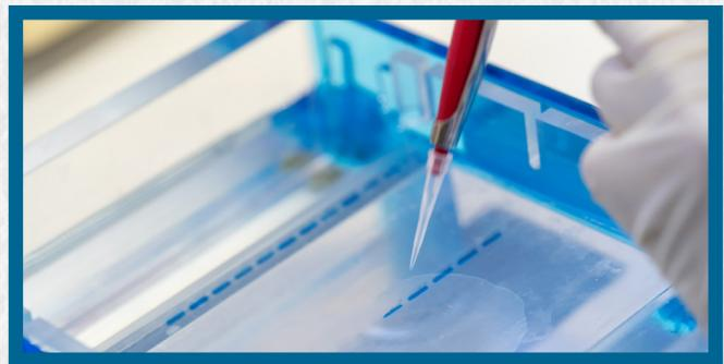
Demonstração de aplicação de amostra nos poços de um gel
